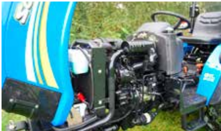
Pour les opérations de maintenance, le capot entier bascule vers le haut, ce qui permet d'accéder facilement au moteur.
