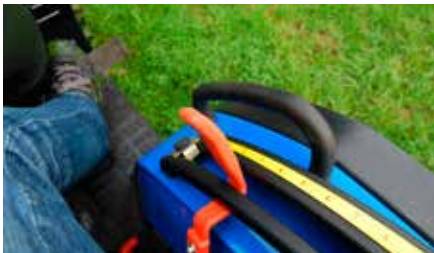
La commande du relevage arrière est placée sur le garde-boue droit et se révèle très ergonomique et de plus facile à commander avec précision.
