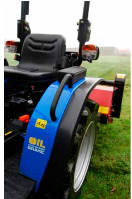
Les garde-boue sont réalisés en acier et sont donc plus résistants que les modèles en plastique.
