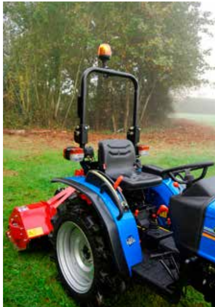
L'équipement de série comporte également l'éclairage routier et un arceau de protection, ce qui permet d'inscrire ce tracteur pour circuler sur la voie publique.
